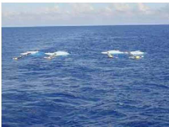
写真-17 エアガン発震風景(発震音は船上においても感じ取れる)
