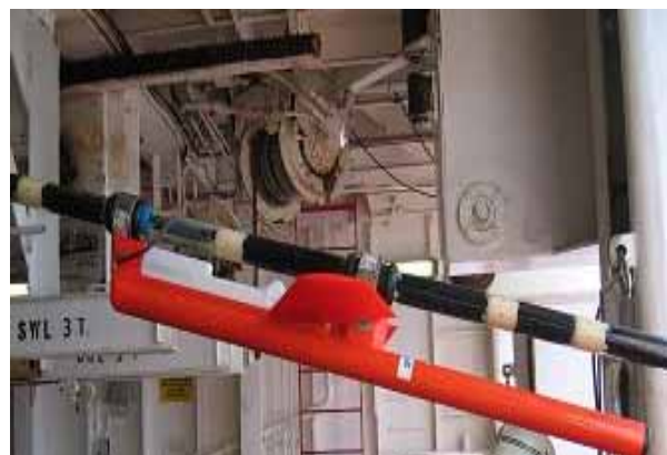
写真-14 ストリーマケーブルに取り付けられたコンパスバード (300m 毎に取り付けるのが一般的である)
