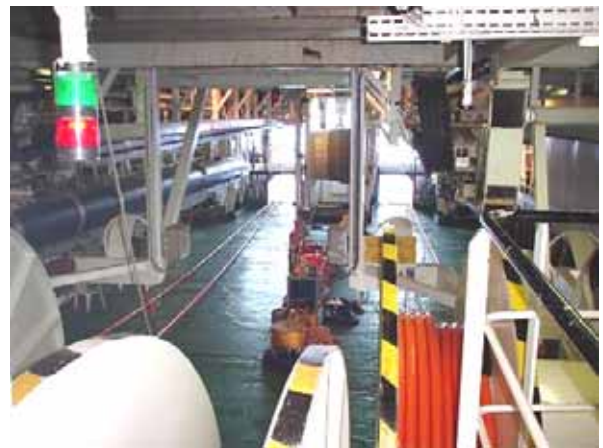
写真-7 エアガンおよびストリーマーケーブルを曳航中の第4層後部エアガンデッキ
