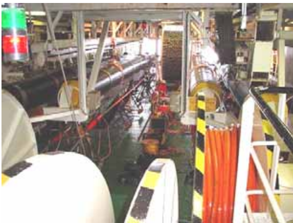
写真-6 エアガンおよびストリーマーケーブルを収納した状態の第4層後部エアガンデッキ
