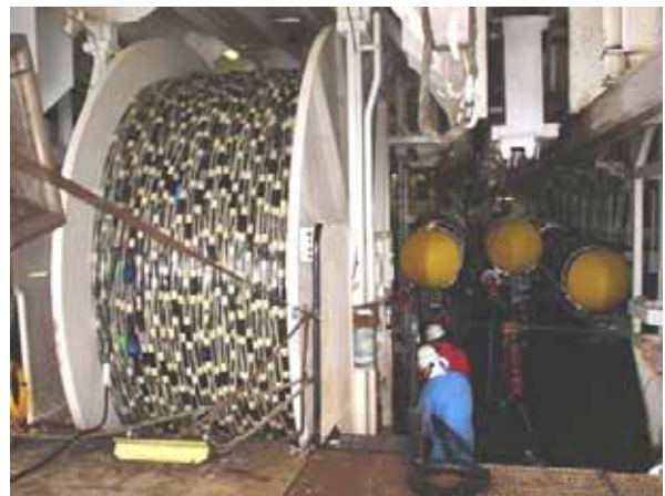
写真-13 6,000m のストリーマケーブルを巻いたウインチと収納状態のエアガンアレイ (右)
