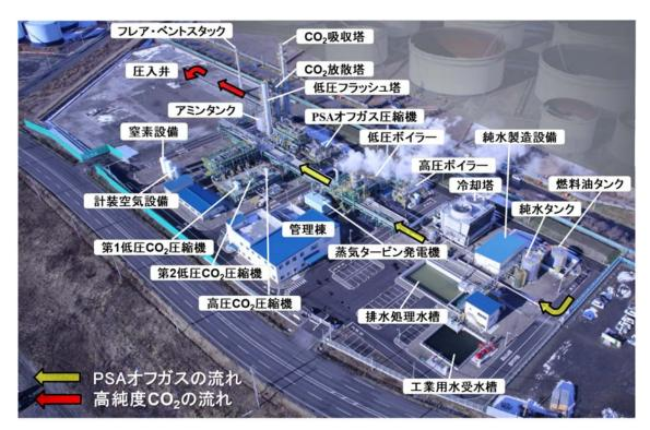
図 1.3-1 分離・回収/圧入設備の俯瞰図
