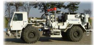
大型バイブレータ震源
